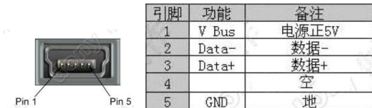
Mini-USB 插座及引脚定义
